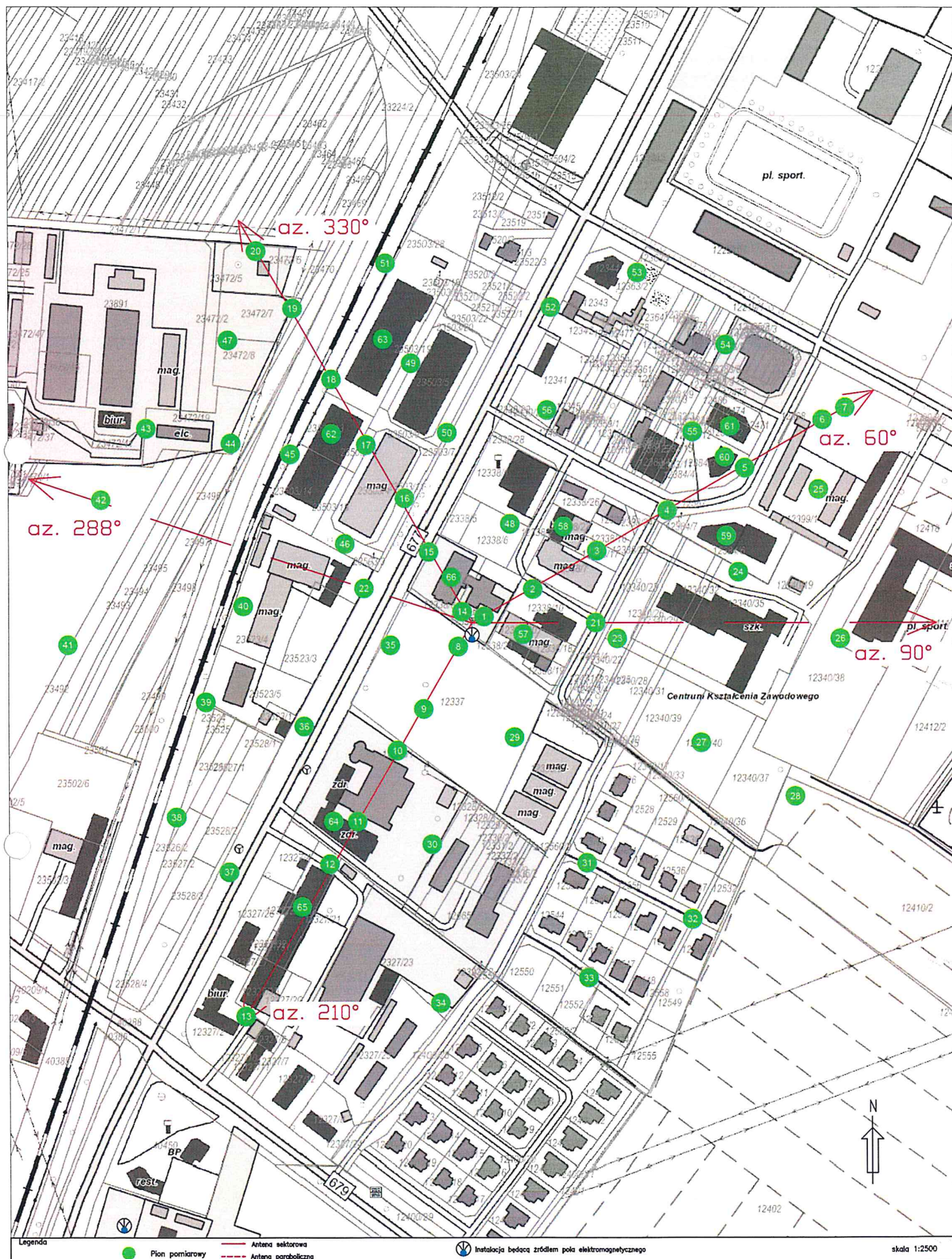
Rys.1 Lokalizacja pionów pomiarowych
